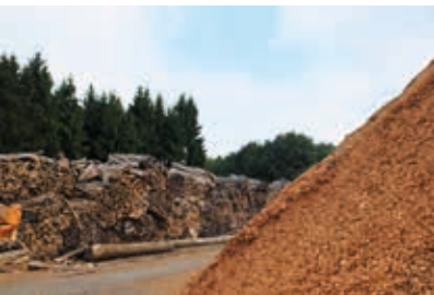
Les dosses et chutes de sciage peuvent servir à la production de plaquettes (chips) de bois à destination des chaufferies
